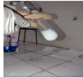
Gambar 3. Dicatat waktu timbulnya gas dan tingkatan kekeruhan air kapur
